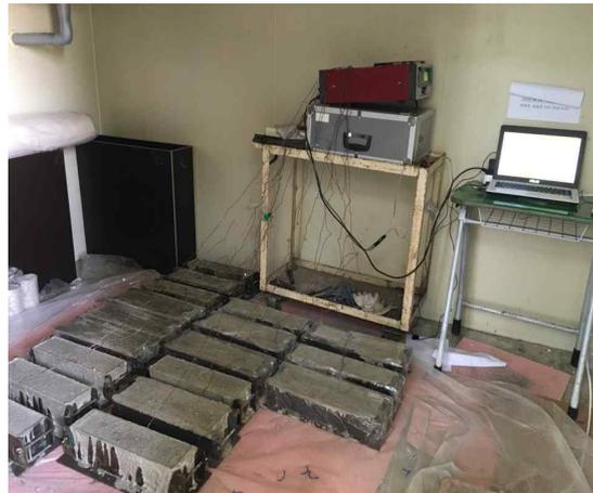
그림 3-25 건조수축 시험 전경
