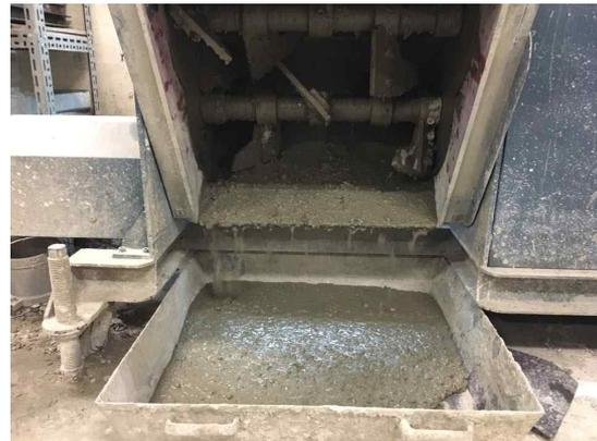
그림 3-9 콘크리트 혼합 믹서(b)
