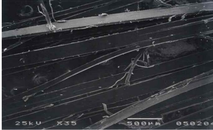
그림 2-15 PP섬유의 SEM 사진
