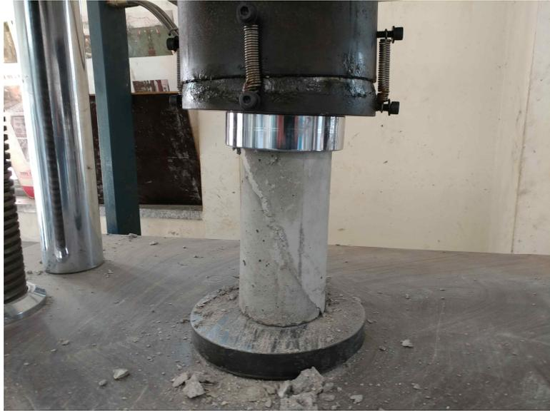
그림 3-18 경사전단접착강도 시험
