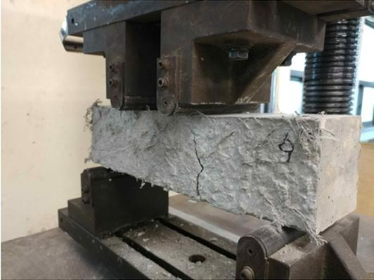
그림 3-16 휨강도 시험
