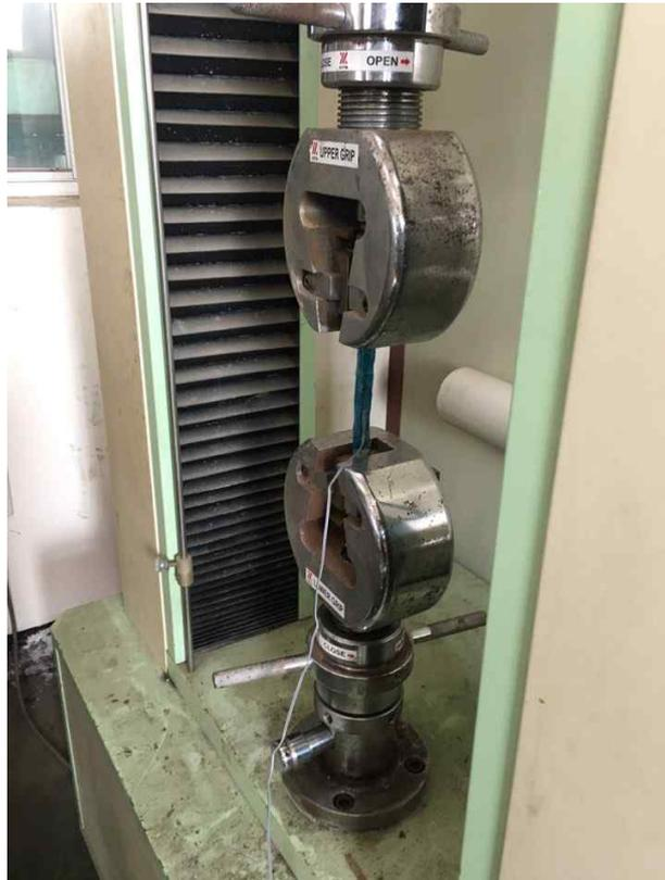
그림 3-4 인장강도 시험
