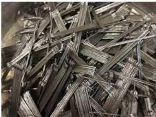
그림 3-5 Steel Fiber의 형상
