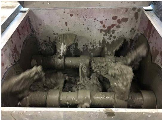
그림 3-8 콘크리트 혼합 믹서(a)
