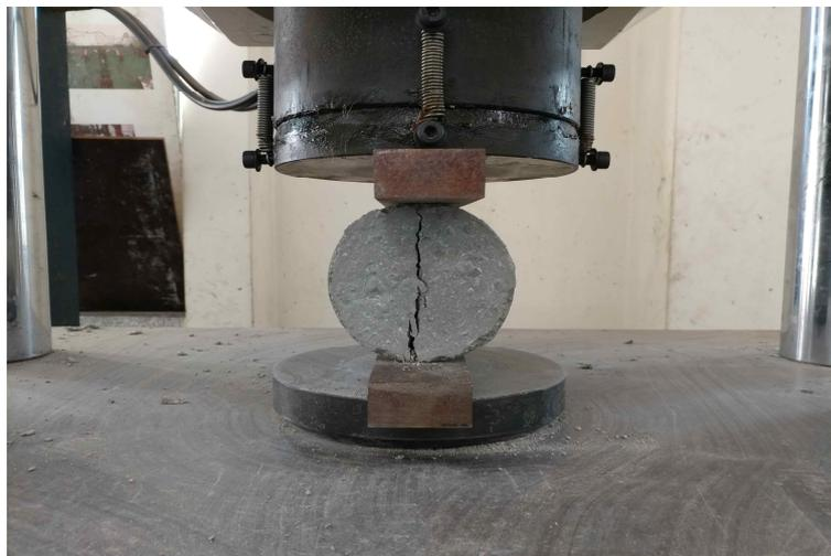
그림 3-15 쪼갬인장강도 시험
