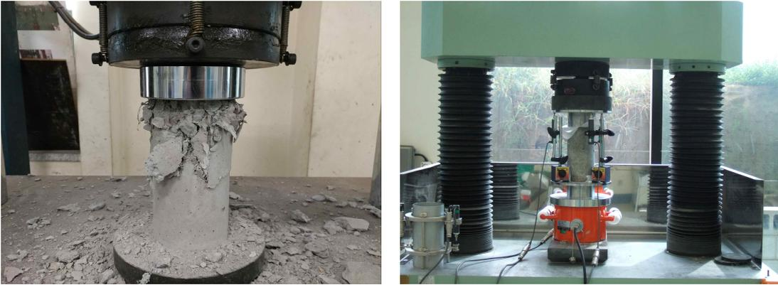
그림 3-14 압축강도 시험
